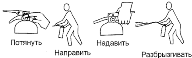
Рис. 7 Последовательность использования огнетушителя
